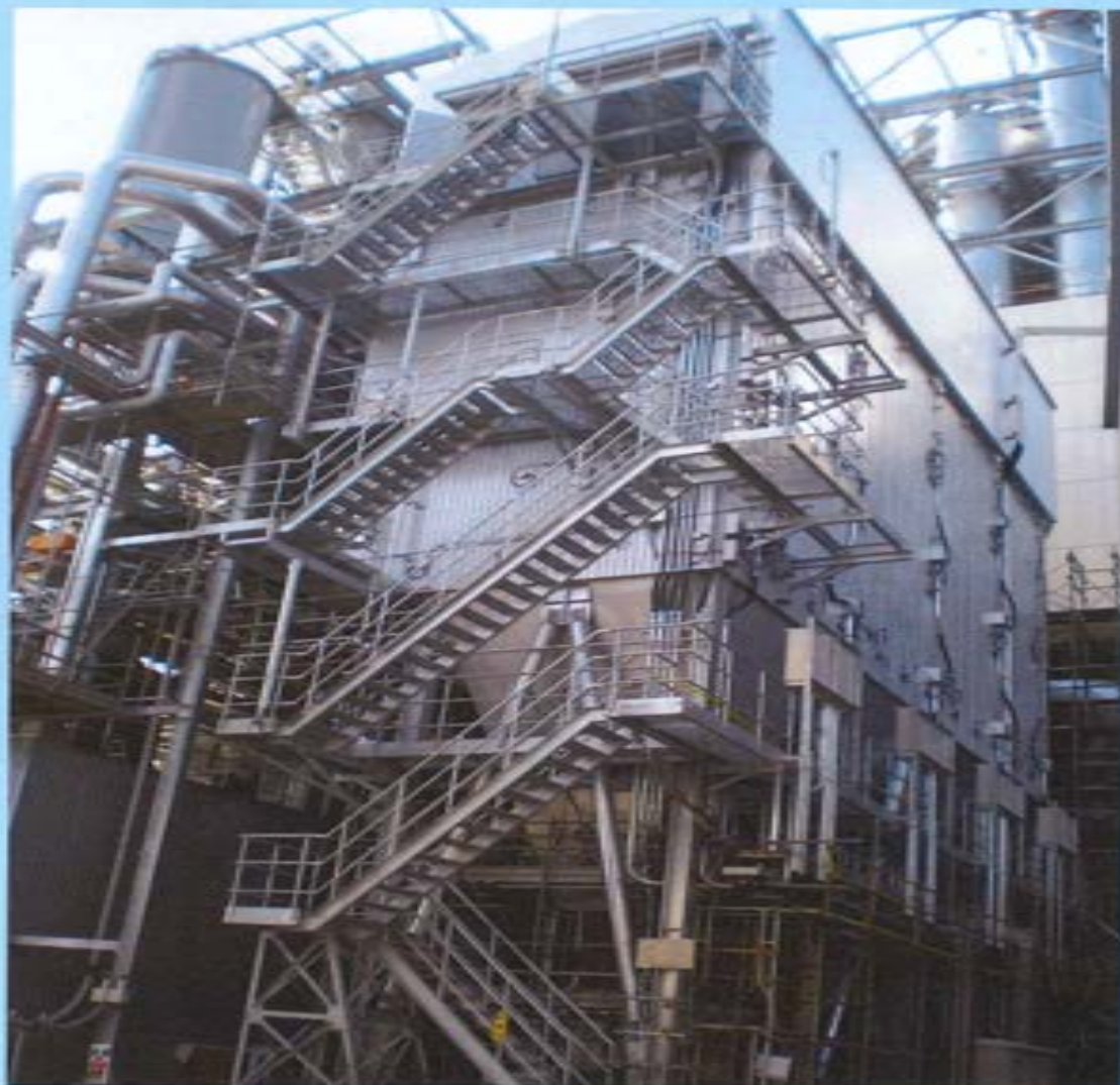
4室バグフィルタ 2,600Nm 3 /min 処理 (バイオマス用)
