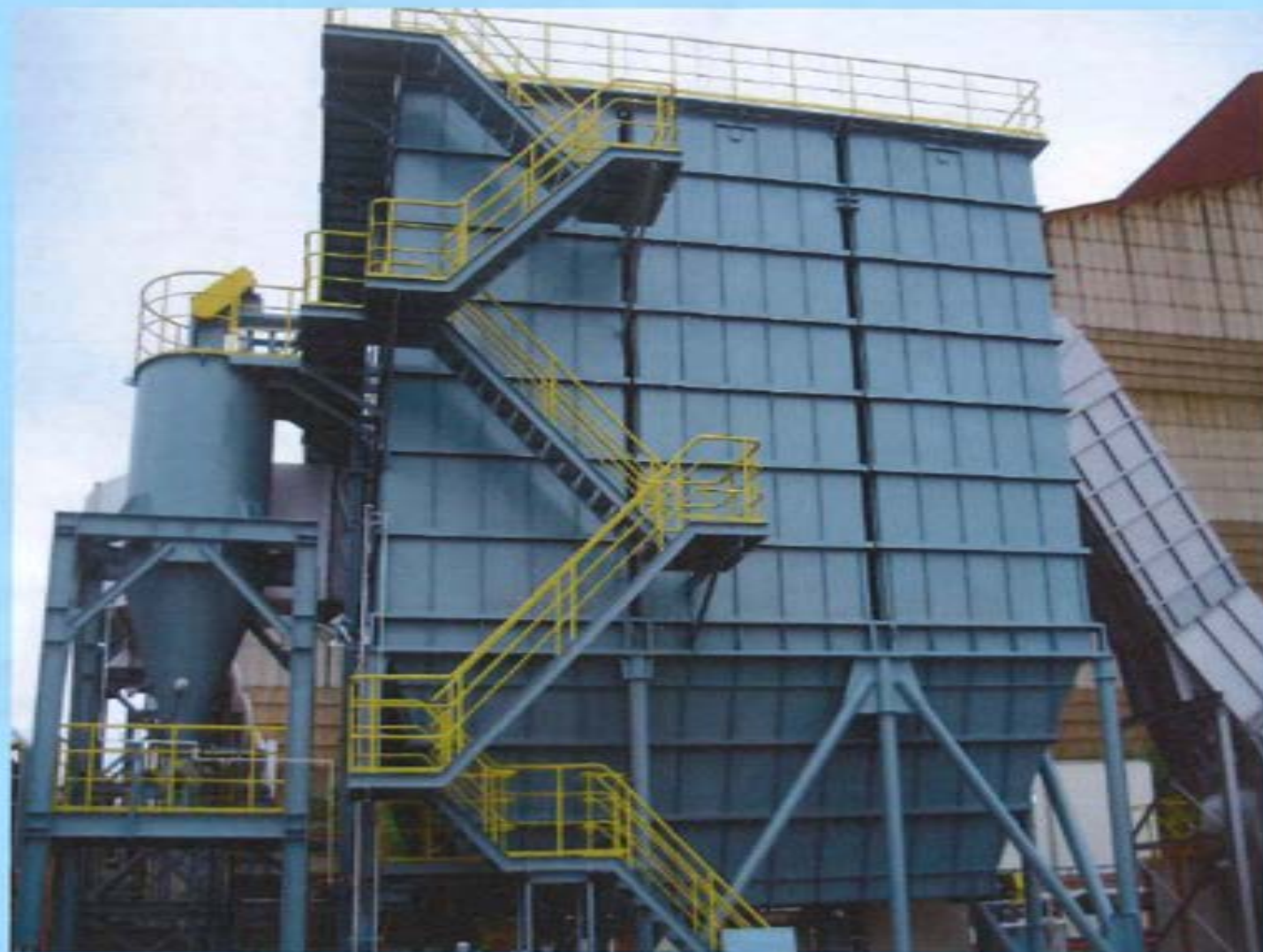
6室バグフィルタ 4,000 m 3 /min 処理
